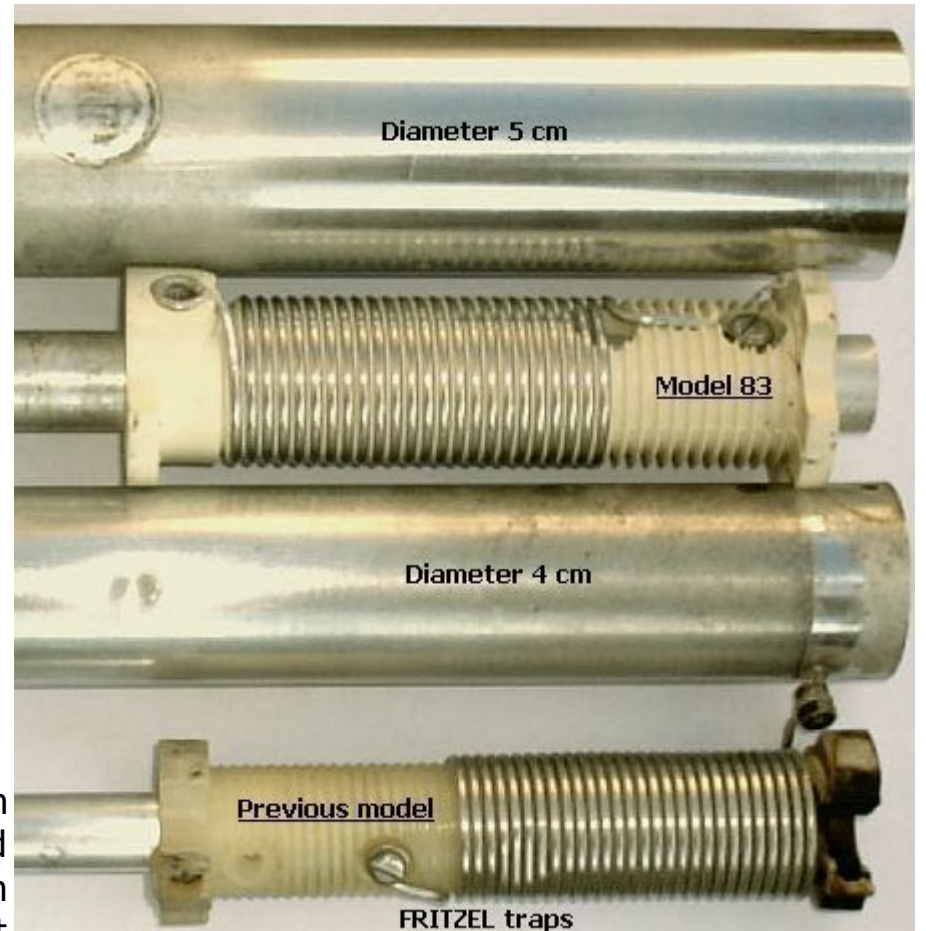
Bovenaan: Fritzel model 83 trap, Onderaan: vonkoverslag en beschadiging in een ouder model.
