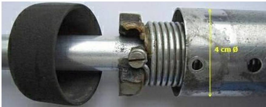
Schade door teveel vermogen bij een vervuilde oud type trap.
