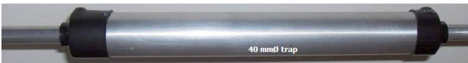
Krimpkaus als afdekdop voor 40 mm diameter traps.
