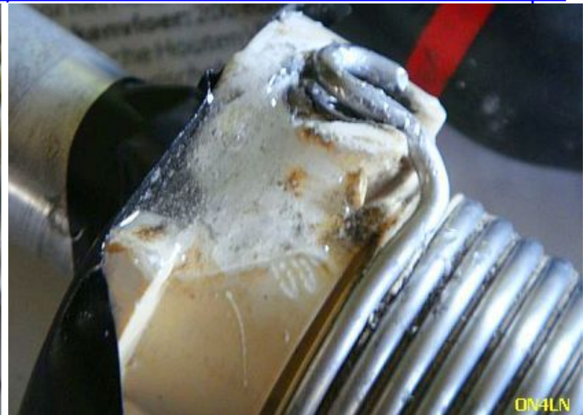
Door eerst het verbrande deel met een frees te verwijderen, heeft ON4LN een trap succesvol met twee componenten epoxy hersteld.
